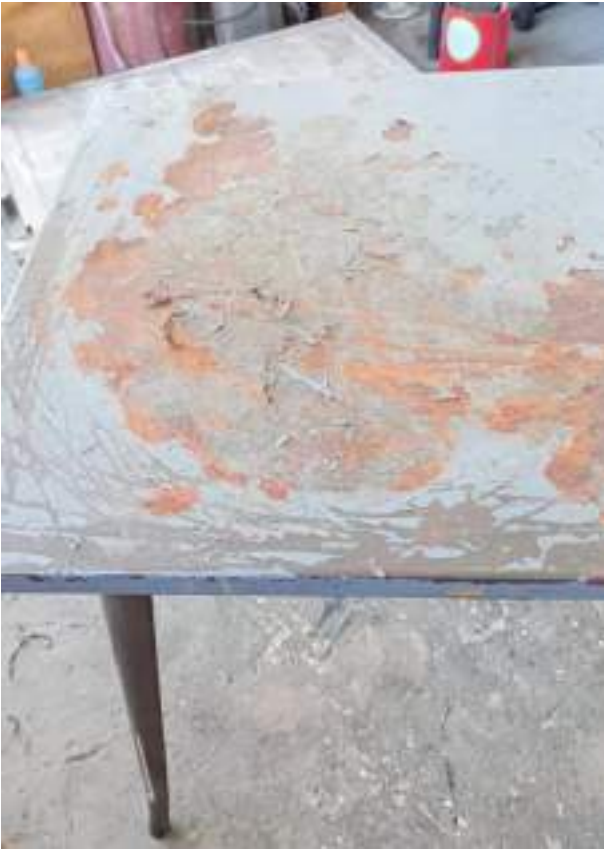
Proses pengerjaan pengamplasan (menghilangkan cat lama) dan pelapisan cat epoxy (anti karat)
