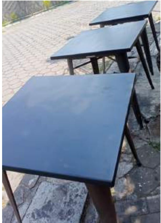
Proses pengerjaan pengamplasan (menghilangkan cat lama) dan pelapisan cat epoxy (anti karat)
